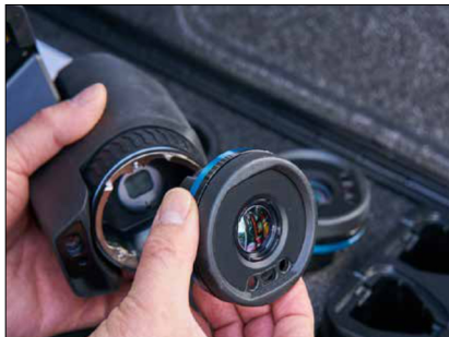
得益於AutoCal™光學部件，該熱像儀可與各系列熱像儀共用鏡頭(從廣角到長焦鏡頭)
