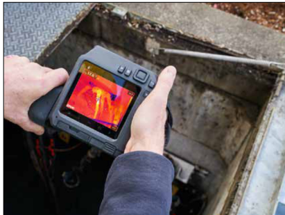
解析度高達161,472像素，可測得遠距離目標的精確讀數
