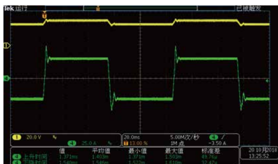
啟動浪湧電流超電流量程，高速建立電壓
