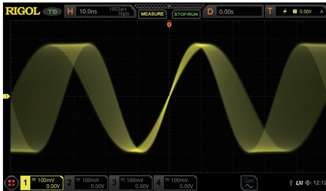
高刷新率模式下扫频信号每一帧的波形变化清晰可见
