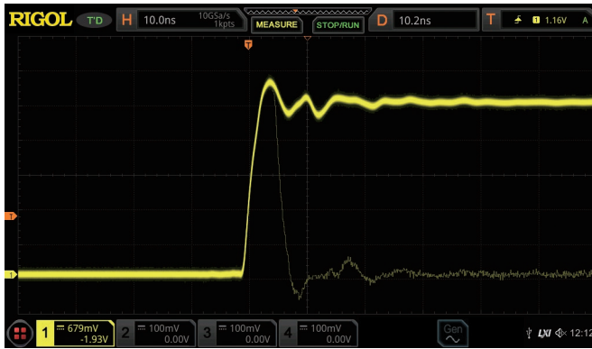
高刷新率模式下捕获偶发异常信号
