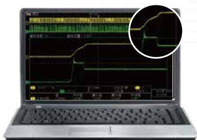
啟動浪湧電流超電流量程，高速建立電壓 (CV-High, CC-Low, CV優先)
