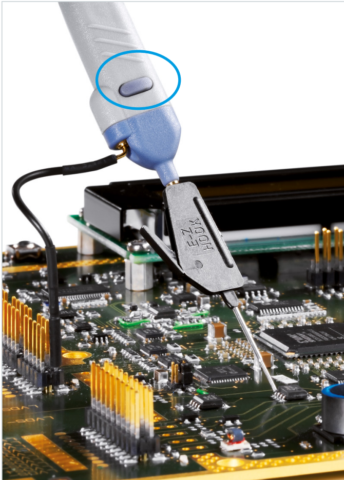
實用設計：帶微控按鈕，方便儀器控制；標配多種探棒尖端和接地電纜
