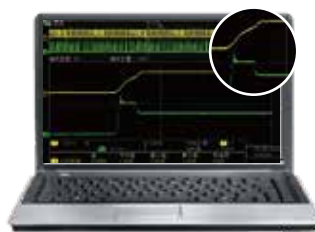
啟動浪湧電流超電流量程，高速建立電壓 (CV-High, CC-Low, CV優先)
